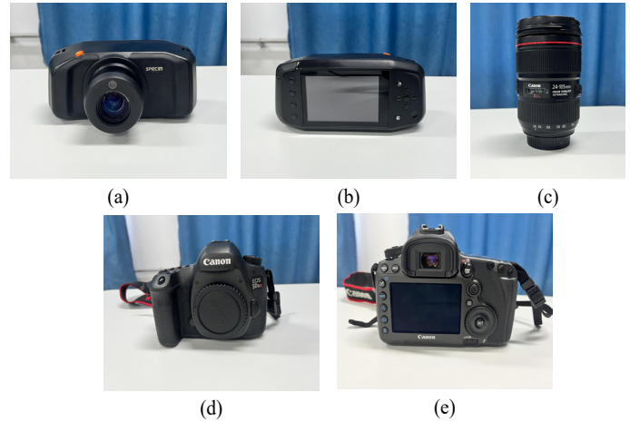
图3 设备信息: (a) SPECIM IQ 相机正面; (b) SPECIM IQ相机背面; (c) EF 24-105 MM F/4L IS USM镜头; (d) Canon 5DS R。
